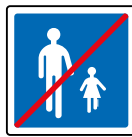
B55 Sortie d'Aire piétonne.
